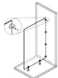
Les vis de TYPE 2 sont spécialement conçues pour le compact HPL et disposent d'un pas large. Vissez avec précaution et fermeté pour préserver la stratification
